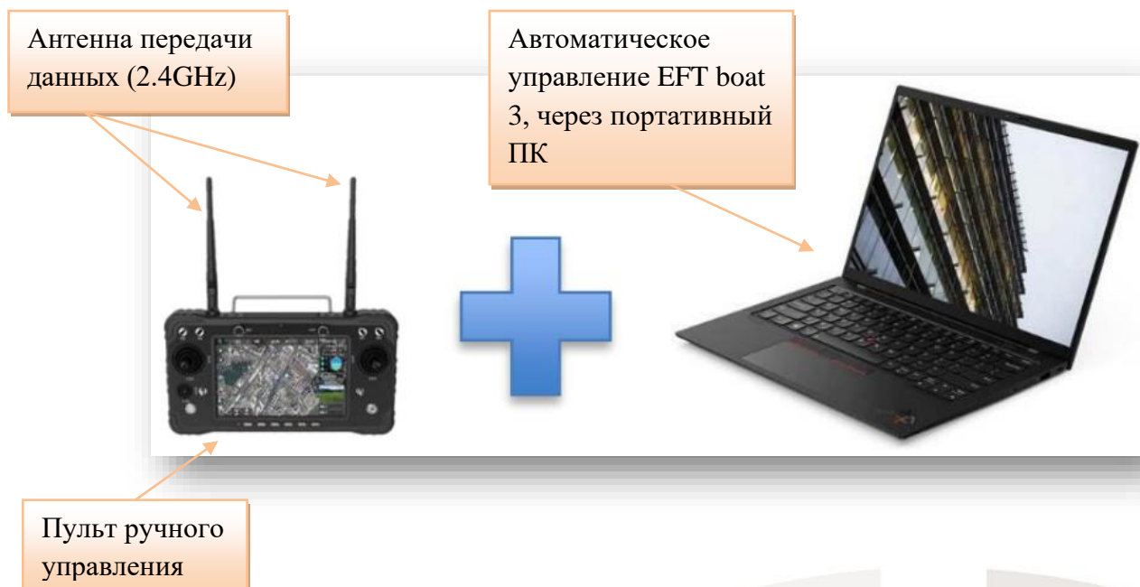
Рис.1.2 Береговая беспроводная система связи
