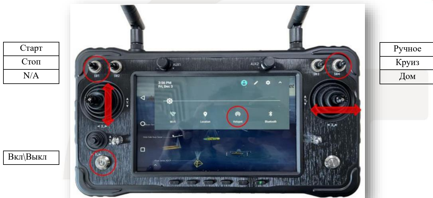
Рис.1.3 Береговая станция беспроводной связи (контроллер)
