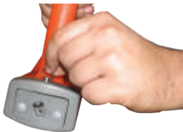
а) Выдвинуть фиксатор, освободить батарейный отсек
