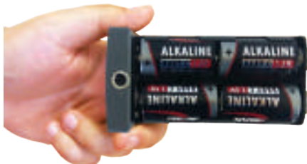
б) Вставить батареи в отсек, соблюдая полярность
