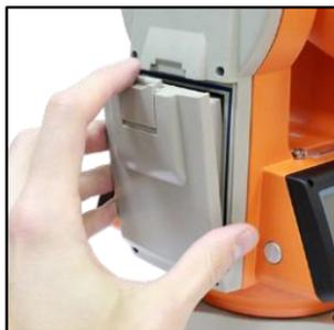
Вставьте аккумулятор нижней его частью в паз, далее, зажав кнопку-защелку, зафиксируйте аккумулятор в корпусе прибора.
