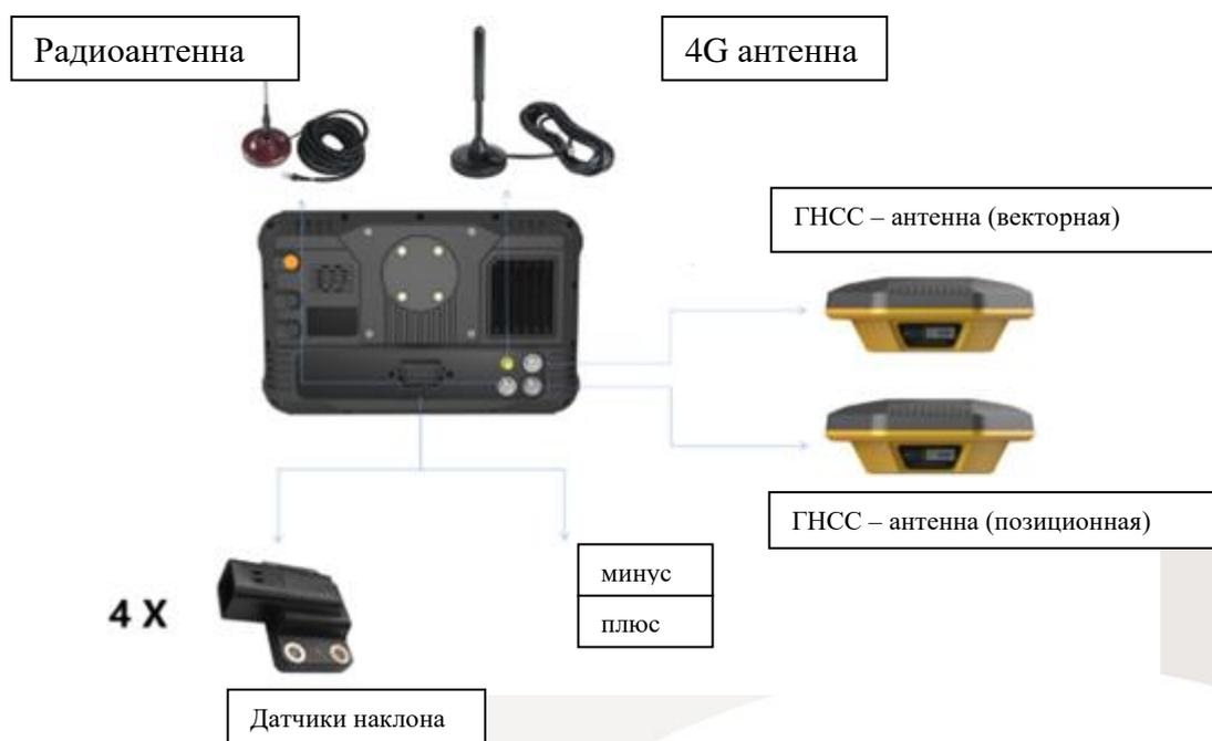
Рис.1.6 Схема подключения основных компонентов
