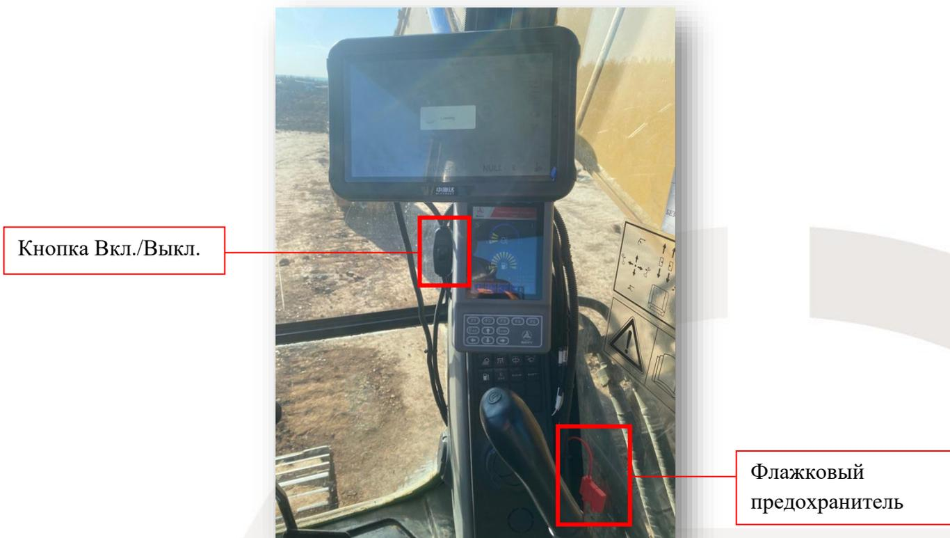
Рис.7.1 Пример установленного планшета в кабине
