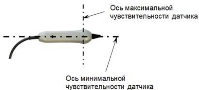
Рисунок А.2. Оси чувствительности датчика MED-127.
