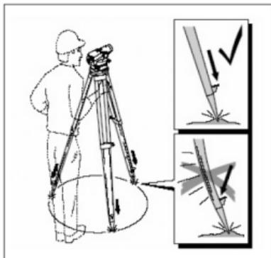
**1.** Ослабьте винты на ножках штатива, выдвиньте ножки на нужную высоту и хорошо затяните винты.
