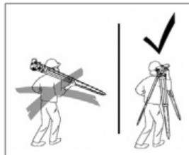
Никогда не перевозите прибор в автомобиле без транспортировочного футляра. Прибор может быть поврежден вследствие ударов и вибрации. При перевозке прибора на поезде, в самолете или на корабле всегда используйте оригинальную упаковку (транспортировочный футляр и картонную коробку). Если прибор намок, оставьте распакованным. Упаковывайте прибор в ящик только после того, как он окончательно высох. При работе в поле всегда держите футляр закрытым.
