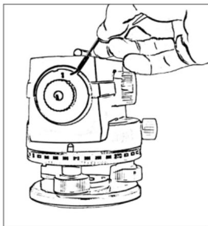
1. Отверните защитную крышку окуляра.
